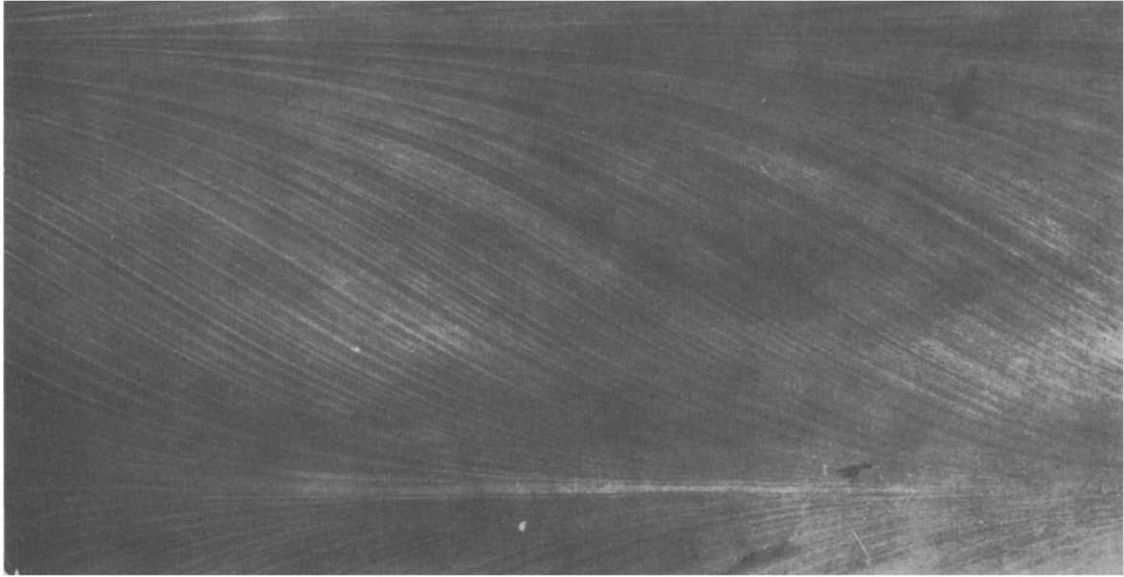
FIG. 6. Résultat de la visualisation des lignes de courant développées dans le plan: Gr = 10^6 ; Pr = 5 ; \phi = 60^\circ .
